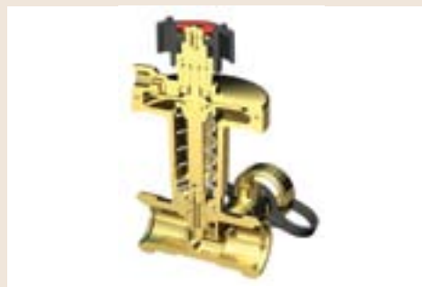
BALLOREX® DP – клапан с возможностью настройки перепада давления, слива и перекрытия теплоносителя
