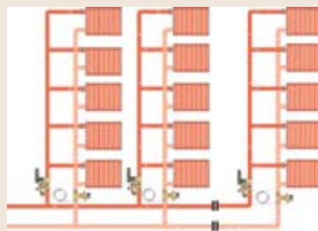
BALLOREX® DP, установленный на стояках систем отопления с терморегуляторами
