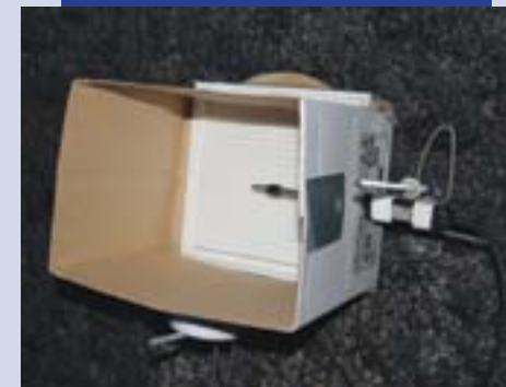
Фото 5. Образец ДПВСВ «УВРК-50», установленный для проведения испытаний (вид с улицы)
